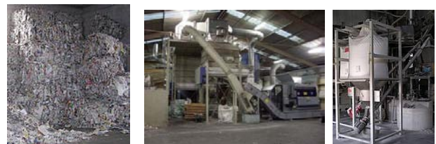
Légende : Le vieux papier trié, réduit dans le dé-chiqueteur, malaxé.
